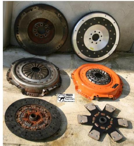
Le mouvement d'entrée est le mouvement de rotation d'axe  $(O, z)$  du vilebrequin du moteur, noté  $S1$ , par rapport au bâti  $S0$ . Le disque d'embrayage  $S2$  est en liaison glissière de direction  $z$  par rapport à l'arbre primaire de la BdV, noté  $S3$ . Le mouvement d'entrée est transmis ou non à  $S3$ , selon le contact adhérent (phase embrayée) ou non (phase débrayée) de la liaison appui plan de normale  $z$  entre  $S2$  et  $S1$ .
